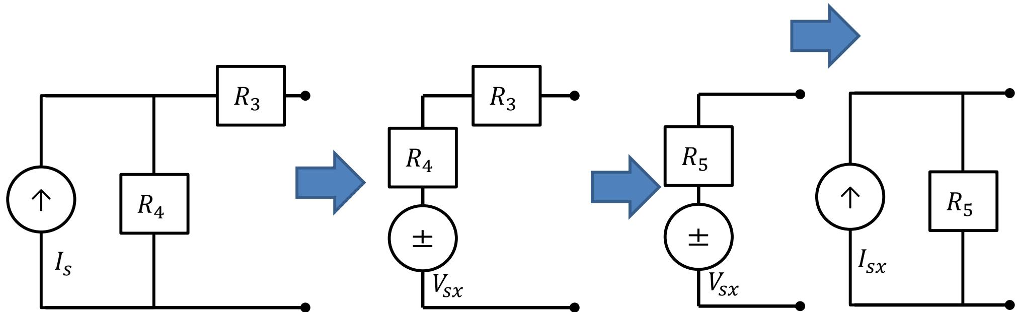
$$R_4 = R_1 // R_2$$
