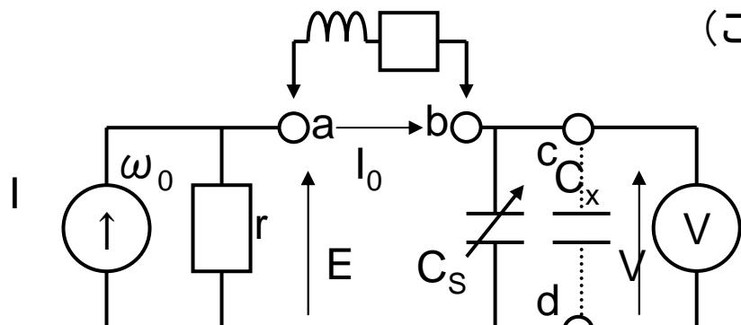
標準可変コンデンサCsを調整、直列共振状態とする
