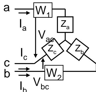
三相平衡の場合は、二電力計法を簡略化した1電力法が可能
