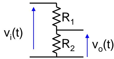
$$v_i(t) : v_o(t) = R_1 + R_2 : R_2 \quad \Rightarrow \quad V_i(s) : V_o(s) = R_1 + R_2 : R_2$$
