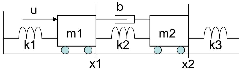
$$\begin{cases} m_1 \ddot{x}_1 = -k_1 x_1 - k_2 (x_1 - x_2) - b(\dot{x}_1 - \dot{x}_2) + u \\ m_2 \ddot{x}_2 = -k_3 x_2 - k_2 (x_2 - x_1) - b(\dot{x}_2 - \dot{x}_1) \end{cases}$$
