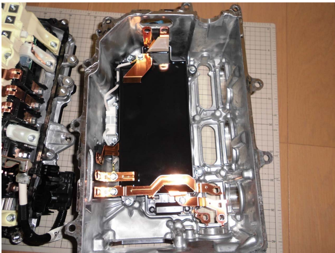
フィルムコンデンサを蓋から外したところ
