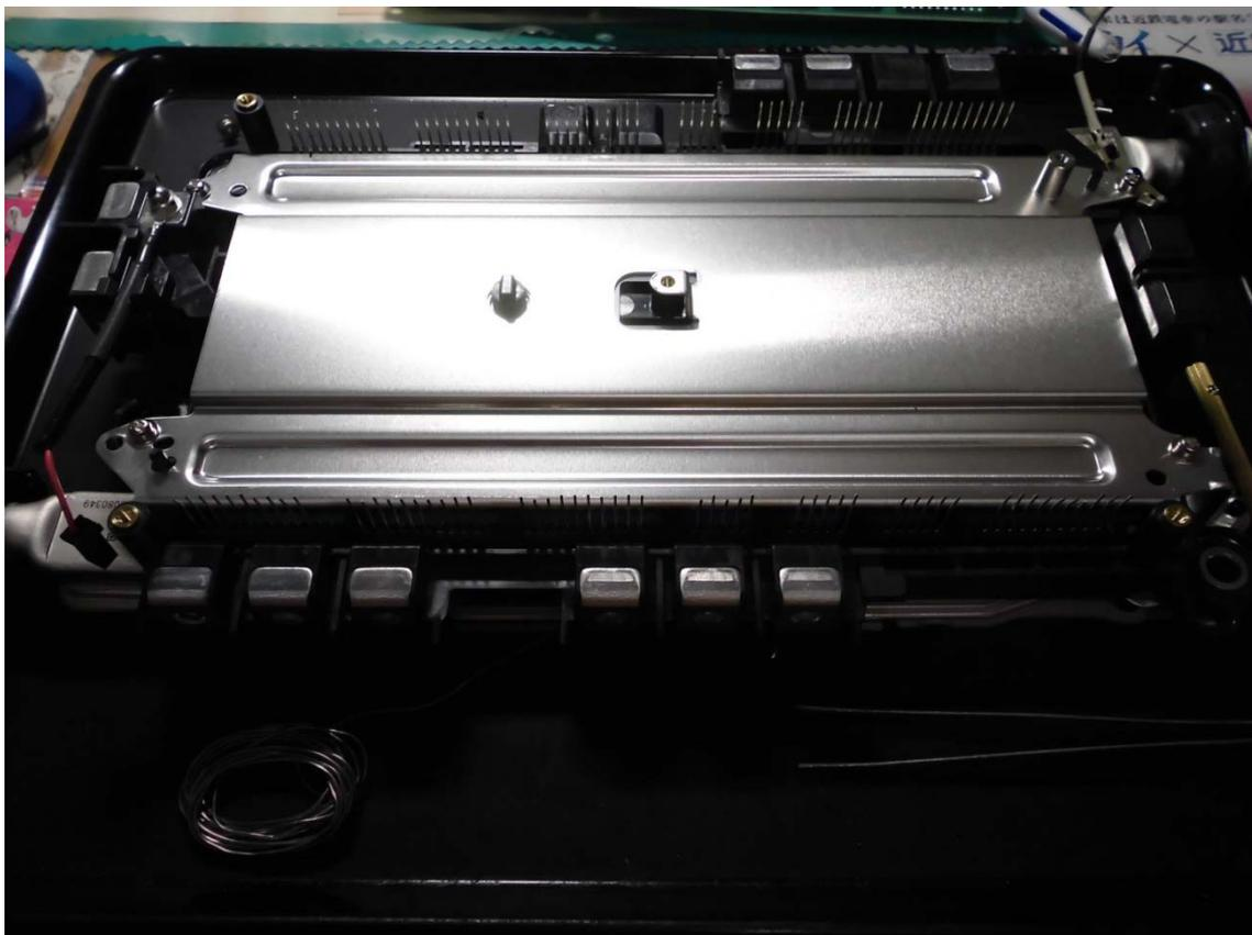
インバータ部プリント基板下のシールド板
